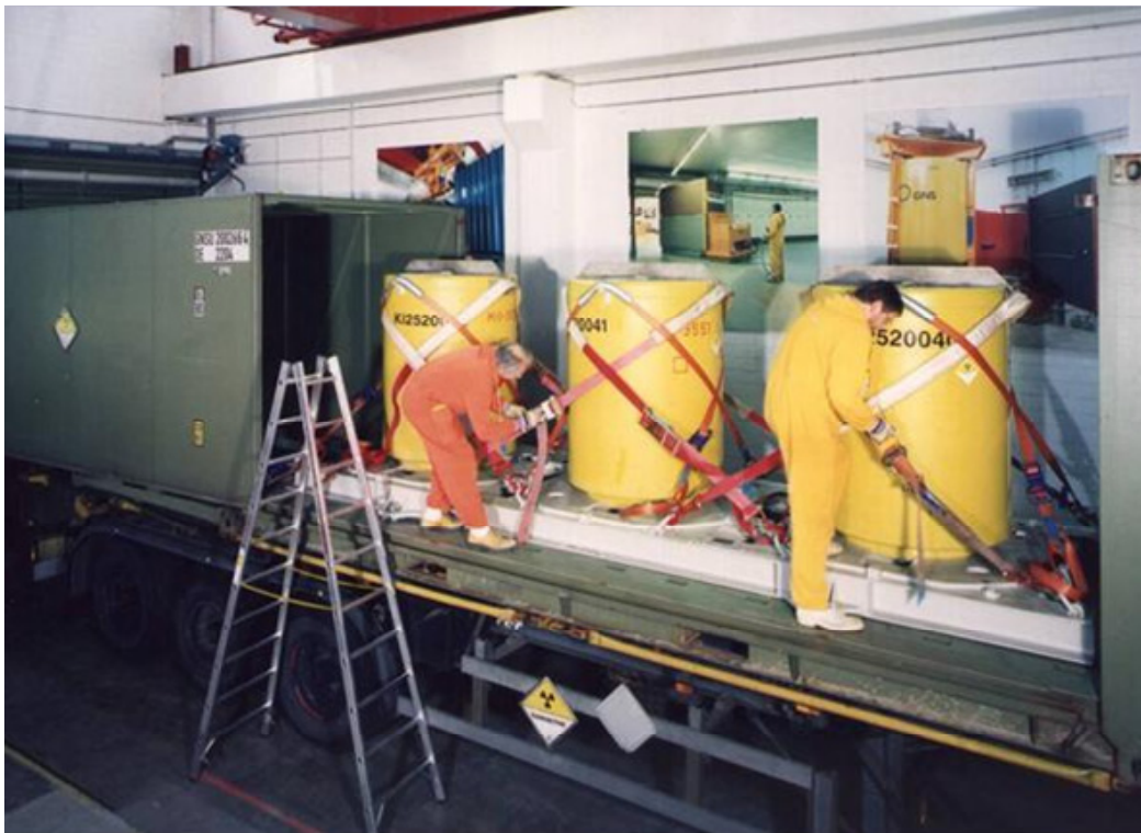
Abb. 18: Gussbehälter als IP-2 Versandstück im 20'-Container
