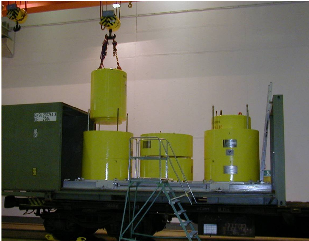
Abb. 19: Gussbehälter als Typ B-Versandstück im 20'-Container
