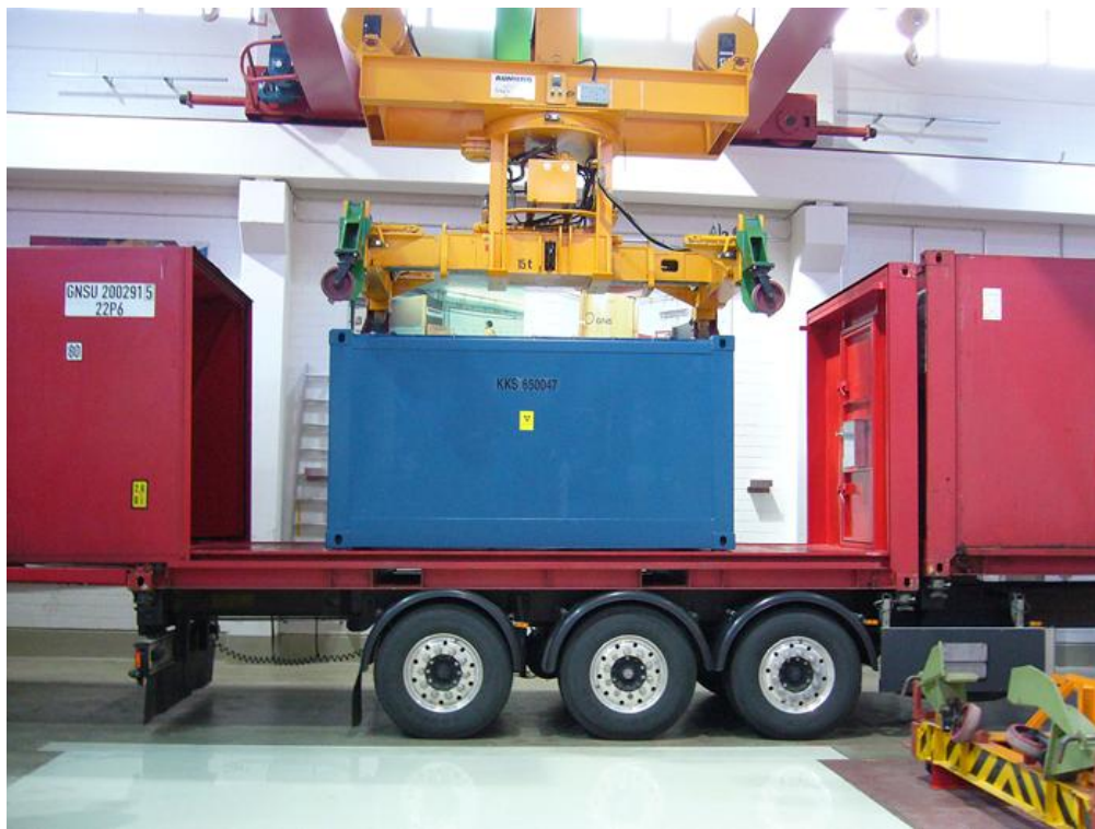
Abb. 16: 20'-Container mit Endlager-Container auf LKW
